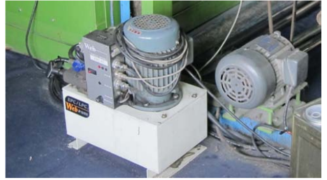
Kontrolör Seri 67 direk TOUGU DENKI Hidrolik Aktüatör üzerine yüklenmektedir.
